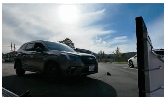
センサーの動きや障害物の前で車両が停止する様子
